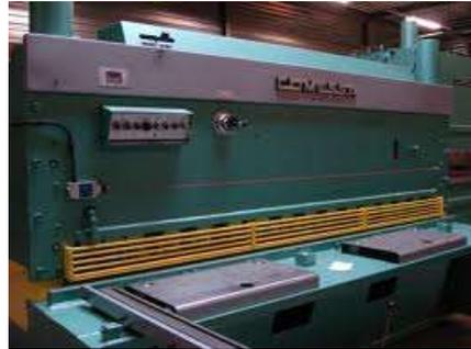
Si le coulisseau refuse de descendre alors que l'on appuie sur la pédale, c'est que l'électro aimant est HS. Il n'est pas nécessaire de le changer. Nous possédons en stock es bobines interchangeables.
