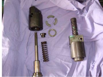
6. Déposer les joints et les changer en les graissant copieusement. Attention au sens...
