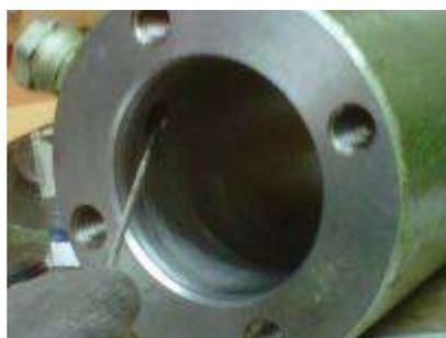
5. Très important : Passer la pierre et la lime sur l'orifice de remplissage dans le fût afin d'éviter d'abimer le joint au remontage
