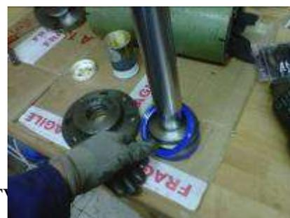
4. Pour reposer les joints sur le piston. Utiliser un cône afin d'écartier le joint mais le chauffer au préalable afin de faciliter le montage. Attention très dur à monter, c'est normal.
