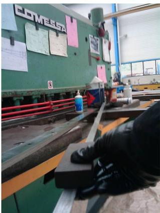
4. On dépose les lames supérieures, si on dispose d'une clé à choc c'est
