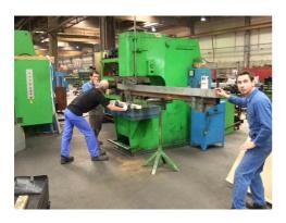
Repose du plat de butée repeint et contrôle de la planéité et réglage
