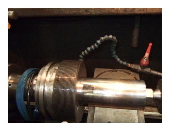
Graissage des joints à la graisse au silicone et remontage en sens inverse
