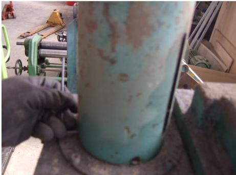
4. Enlever les circlips et les gros écrous de butée.
