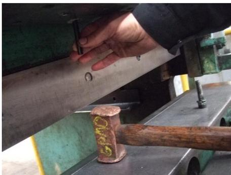
Remontage des serre tôles et essai de coupe sur de la tôle de 20mm
