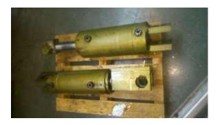
Attention vu la complexité et le temps nécessaire (1 semaine) à la dépose et repose, il est préférable de rénover entièrement les vérins.
