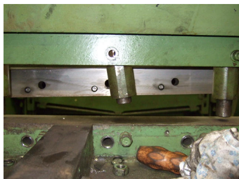
Vue de dessous avec les vis de réglage lames
