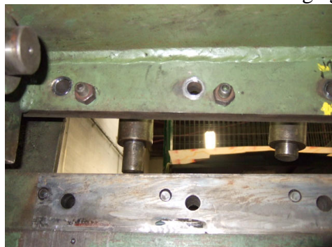
Vue de dessous avec les vis de réglage lames
