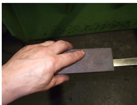
Mesure de l'angle des lames (2 coupes) + passage de la pierre à huile sur les lames
